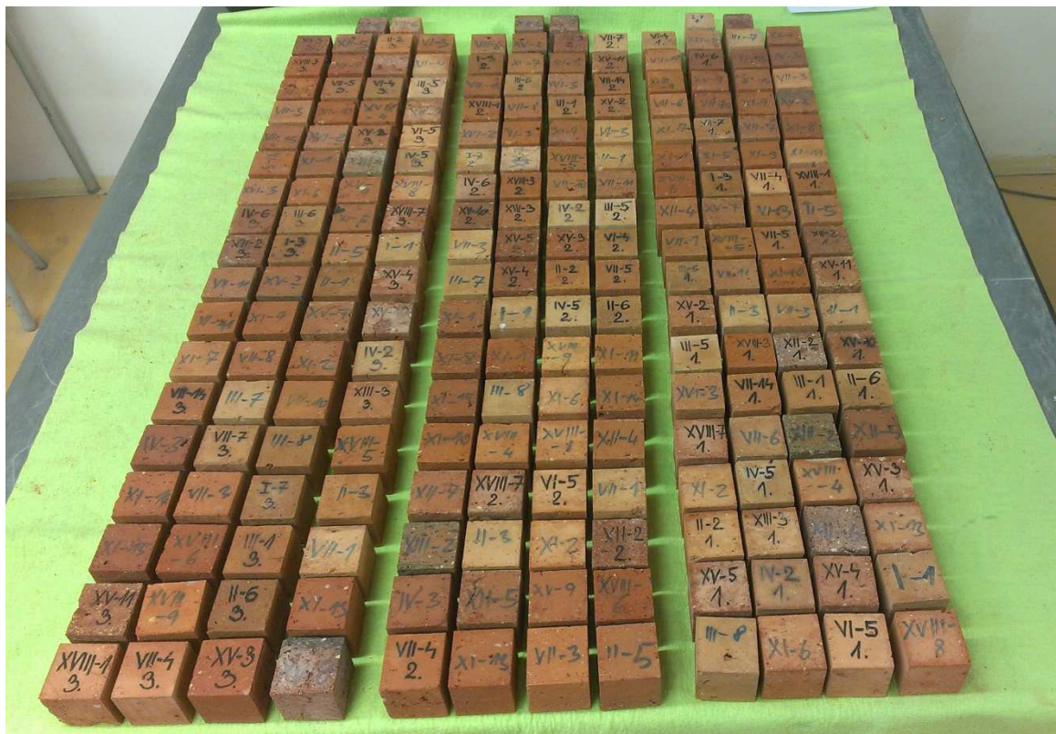
Obr. 3.33 Zkušební tělesa vyřezaná z odebraných vzorků
