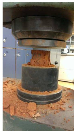
Obr. 3. 46 Detail porušení zkušebního tělesa
