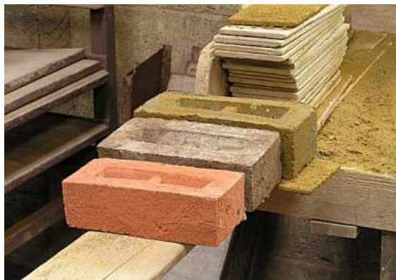
Obr 2. 5 Příklad čerstvé, vysušené a vypálené cihly [25]
