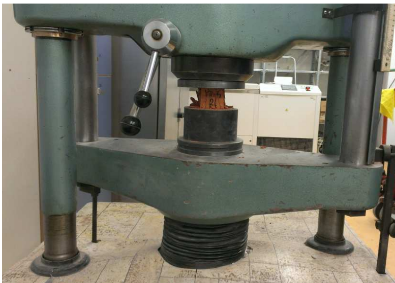
Obr. 3. 45 Zkoušení krychelné pevnosti v tlaku na lisu
