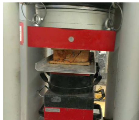
Obr 3. 41 Zkouška pevnosti v tlaku na lisu
