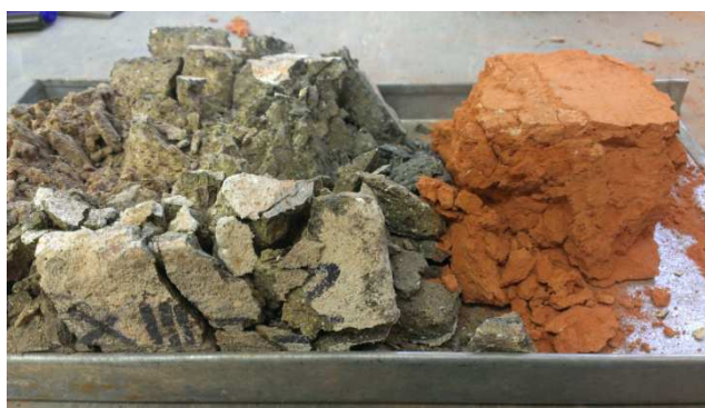
Obr 3. 32 Porušené vzorky – radikální rozdíl v barvě střepu
