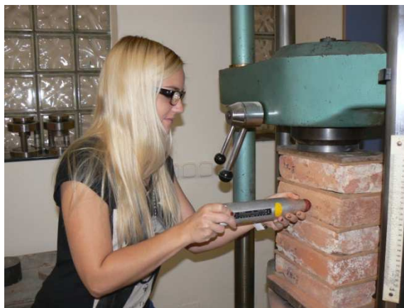
Obr 3. 36 Provádění zkoušky pevnosti v tlaku tvrdoměrem Schmidt LB
