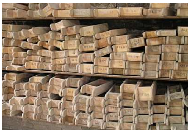
Obr 2. 4 Skladování dřevěných forem v cihelně [25]
