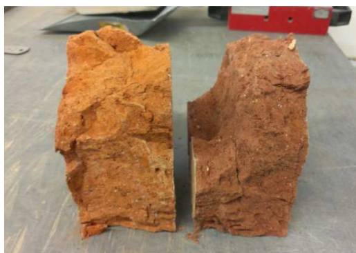
Obr 3. 42 Fragменты vzorku po provedení zkoušky v tlaku (patrná různobarevnost střepu)
