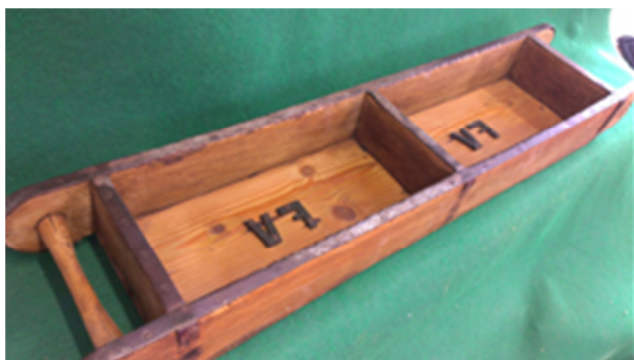
Obr 2. 2 Typický příklad dvojité dřevěné formy užívané při ruční výrobě cihel
