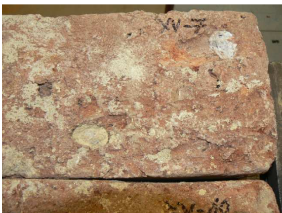
Obr 3. 17 Detail vzorku cihly s výskytem velkých cicvárů
