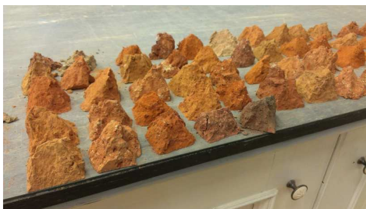
Obr. 3. 34 Korektnost porušení zkušebních těles
