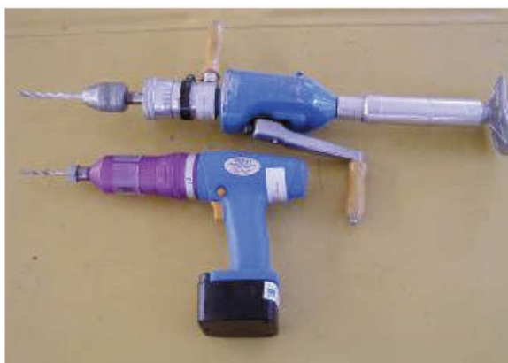
Obr. 2.13 Vrtačky pro zkoušení malty ve spárách (ruční a elektrická PZZ 01) [27]
