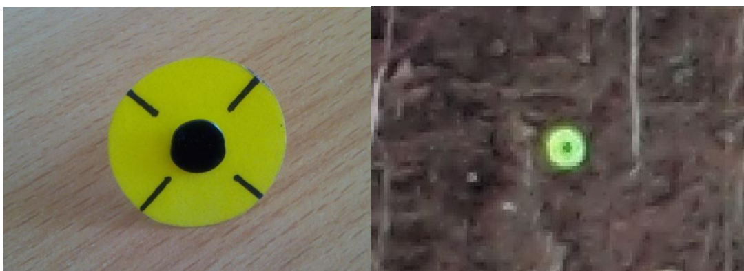
Obrázek 5.5 Ukázka signalizace vřícovacího bodu (vlevo) a zachycení bodu na snímku (vpravo) (foto: H. Uhrová).
