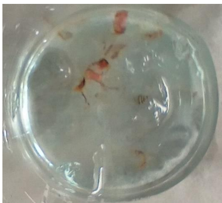
Obrázek 18: Impregnovaný hydrogel 1 týden po přípravě bez přidání kyseliny askorbové.
