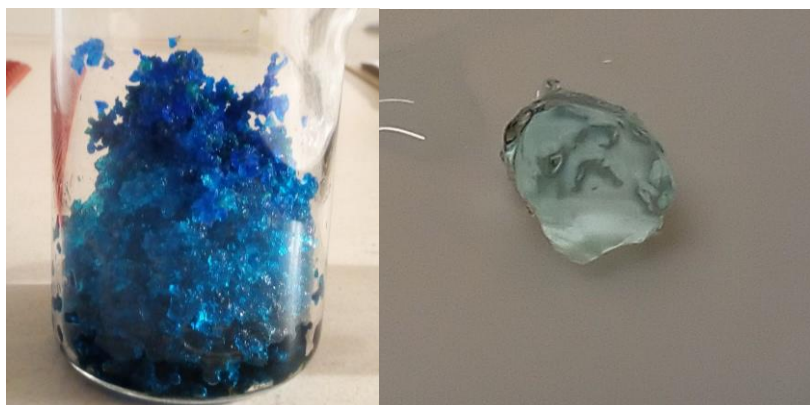
Obrázek 11 a 12: Hydrogel po přidání do roztoku soli o vysoké koncentraci a hydrogel po přidání do roztoku soli s nízkou koncentrací.
