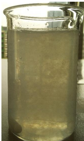
Obrázek 10: Hydrogel H1 impregnovaný nanočásticemi ZnO.
