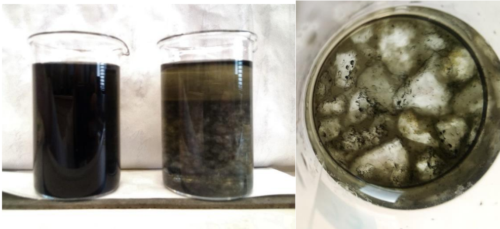
Obrázek 7 a 8: Názorný příklad hydrogelu H1 impregnovaného přidáním disperze CuNPs.
