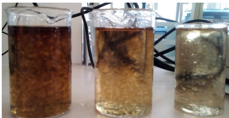
Obrázek 9: Názorný příklad hydrogelu H3 (VUT) impregnovaného vzorkem disperze CuNPs (celková koncentrace v CuNPs v hydrogelu se zmenšuje směrem doprava).
