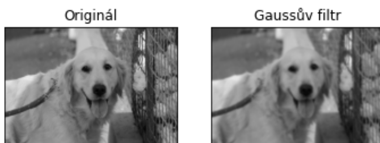
Obrázek 9: Rozostření aplikováním Gaussova filtru
