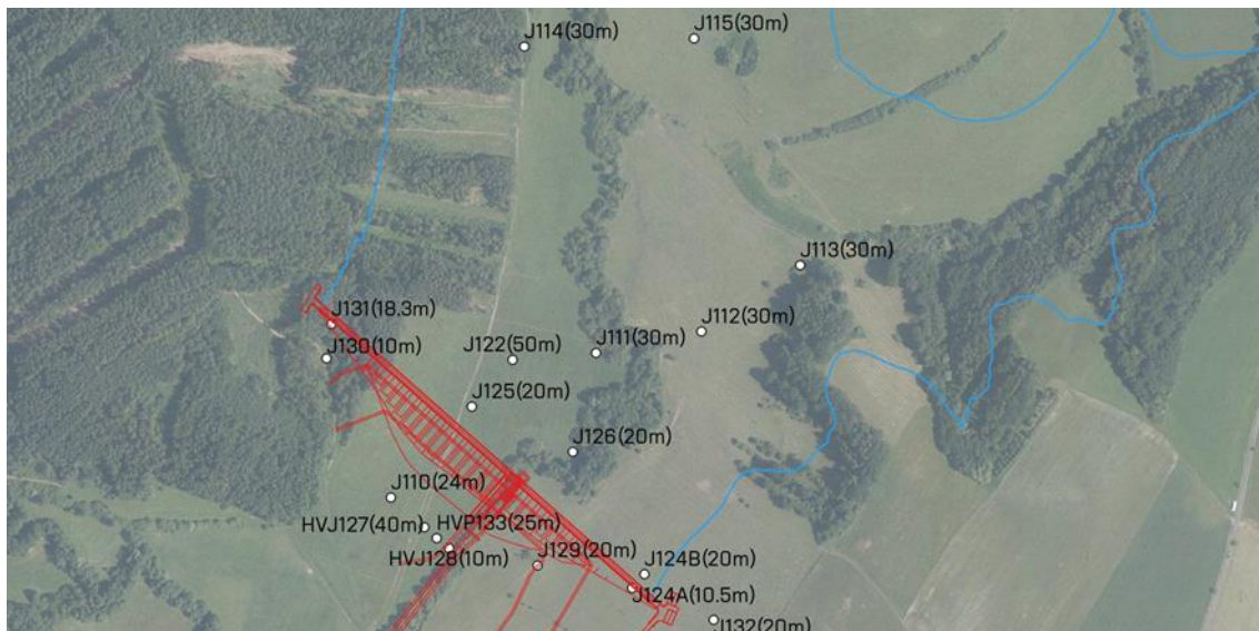
Obr. 4.9: Poloha průzkumných vrtů [III]
