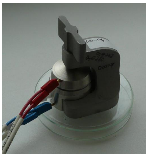
Obrázek 35 – Sestavená ceta se vzorkem elektrolytu pro měření potenciálového okna
