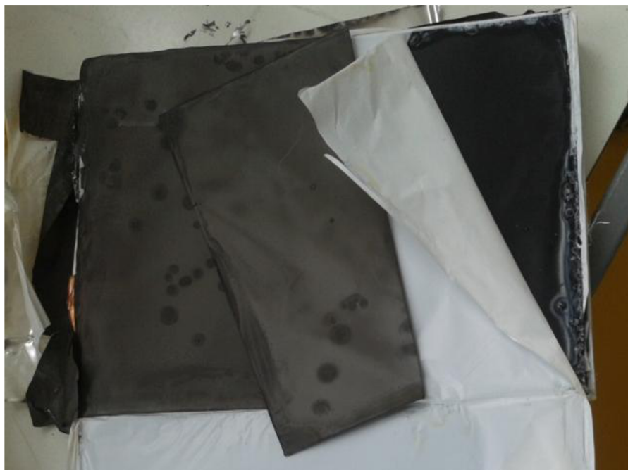
Obrázek 6 - Struktura lithno-iontového akumulátoru
