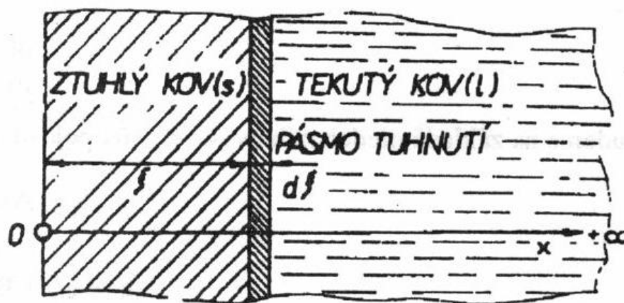
Obr. 1: Tuhnutí polonekonečného odlitku podle Neumanna [2]
