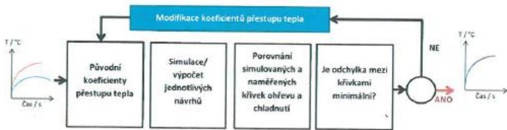
Obr. 10: Schéma inverzního modelování koeficientů přestupu tepla mezi ingoty a kokilou. S programem pro automatickou optimalizaci slévárenských procesů mohou být minimalizovány odchylky mezi simulací získanými a skutečnými teplotními křivkami na vnějším povrchu kokily. [9]
