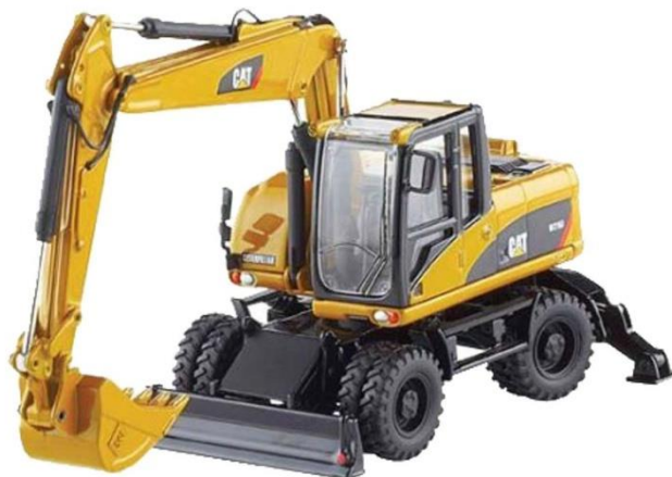
Obr. 2 Kolové rypadlo M316D
