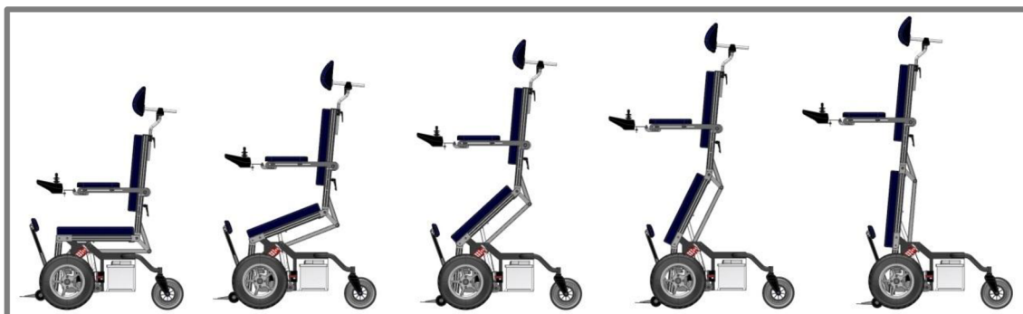
Obr. 7.2-5: Průběh vzpřimování a dosednutí podpůrných koleček mechanismu k zemi
