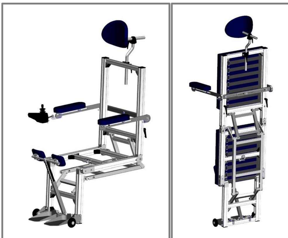
Obr. 7.2-1: Zdvihací mechanismus v základní poloze
