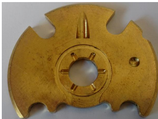
Obr.6.1: Hydrodynamické ložisko turbodmychadla[39]
