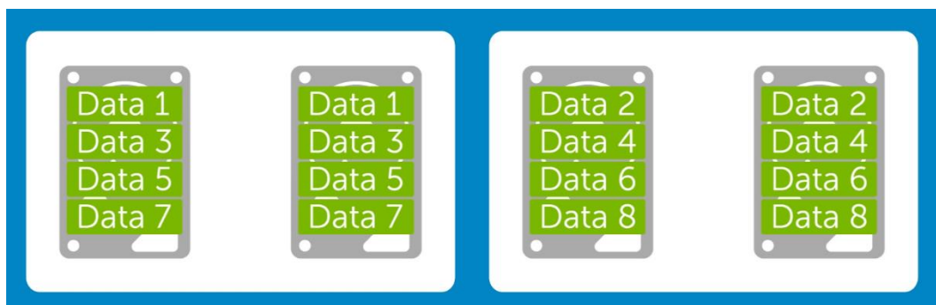
Obrázek č. 11: Způsob ukládání dat u kombinace RAID 1+0 (Zdroj: 7)
