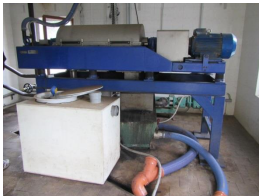
Obr. 20 Strojní dekantální odstředivka (autorka)
