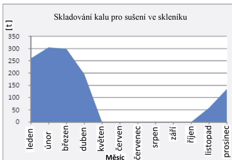
Graf 5: Składování kalu pro sušení ve skleníku solární sušárny
