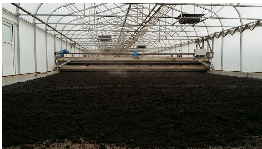
Obr. 25 Solární sušárna HUBER v provozu [18]
