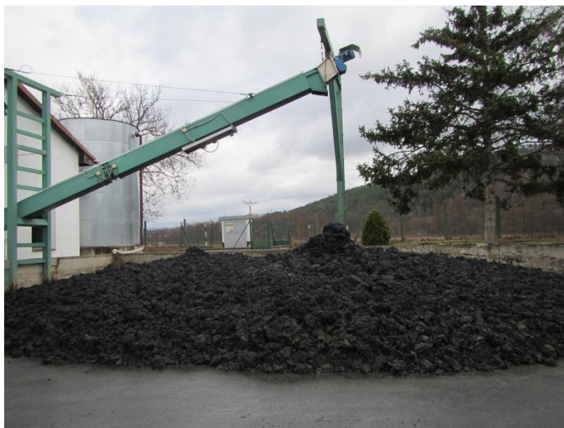
Obr. 21 Šnekový dopravník a deponie odvodněného kalu (autorka)
