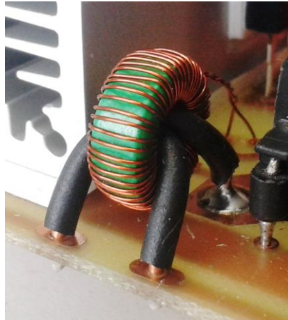
Obr. 4-1 - Prúdový transformátor s dvoma primárnymi prievlekmi
