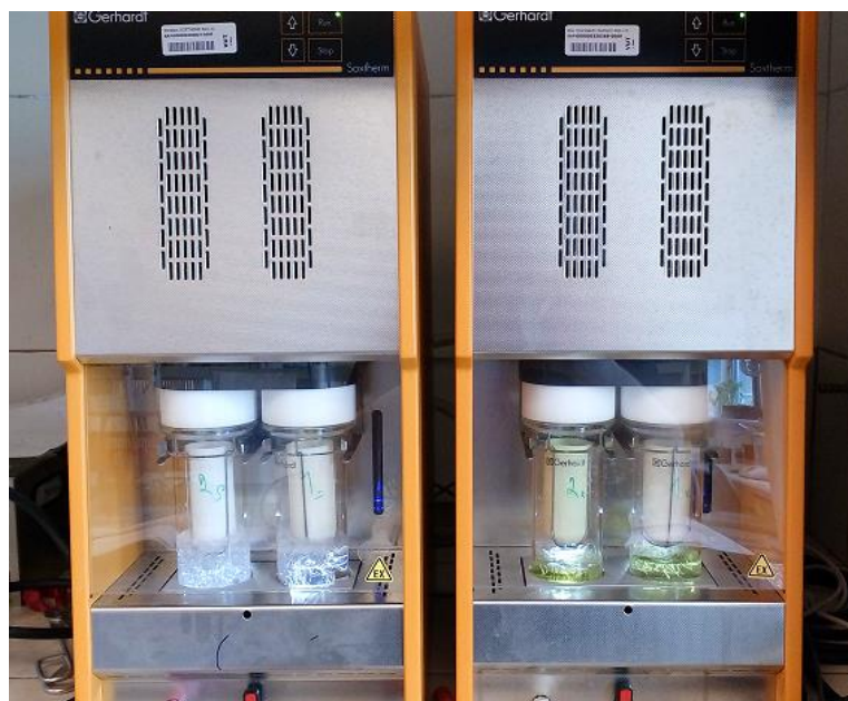
Obrázek 9 Průběh extrakce pomocí přístroje Soxtherm
