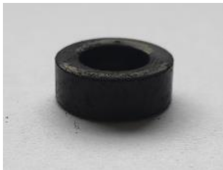
Obr. 4.3: Ukázka jádra nalisovaného pro řízený výpal v trubkové peci
