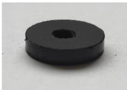
Obr. 4.2: Ukázka nalisované tablety s vyvrtanou dírou ve středu vzorku pro TGA analýzu
