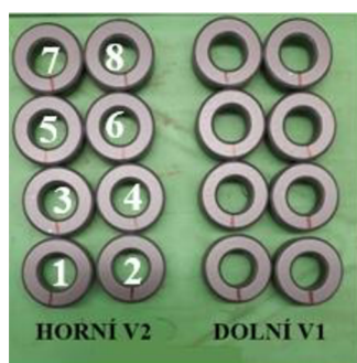
Obr. 4.16: Označení jader R38,1 dle polohy na lodičce
