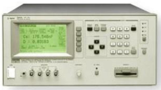
Obr. 4.10: Můstek pro měření permeability
