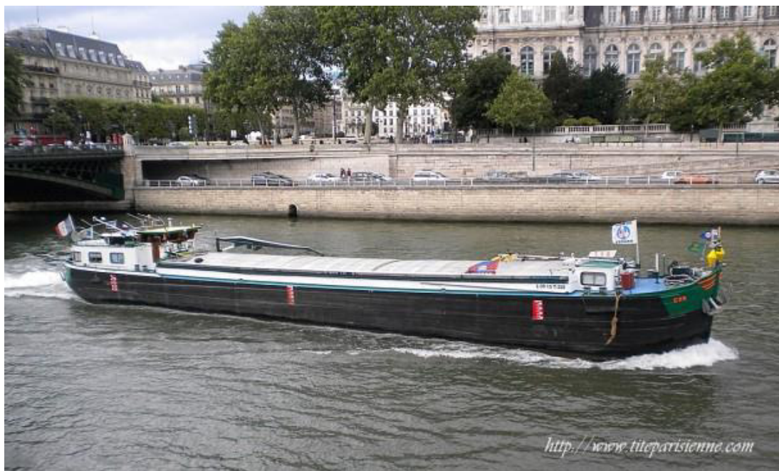
Obr. č. 6.: Návrhové plavidlo typu Péniche, francouzská řeka Seina, plavební třída I.
