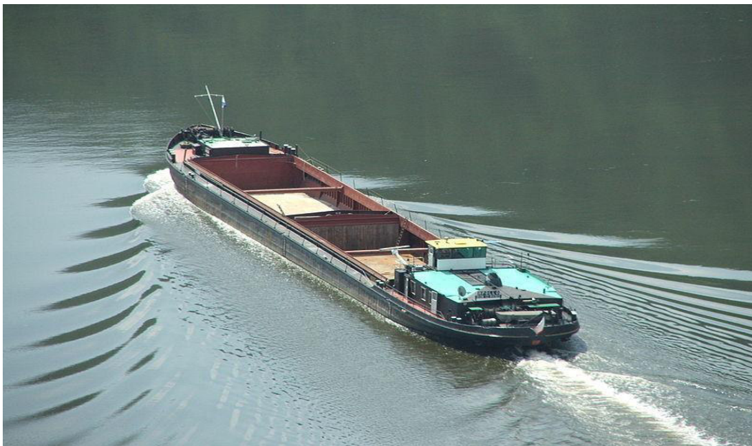
Obr. č. 10.: Návrhové plavidlo typu Johann Welker, plavební třída IV.
