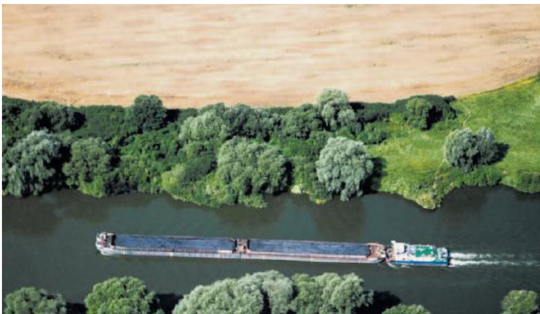
Obr. č. 12.: Návrhová tlačná sestava typu Europa II, plavební třída Vb.
