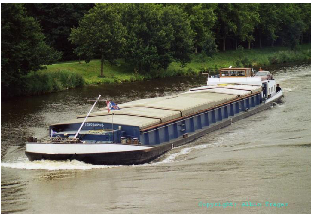
Obr. č. 9.: Návrhové plavidlo typu Gustav Koenigs, plavební třída III.
