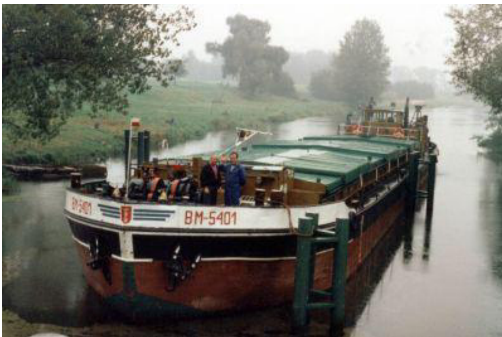
Obr. č. 8.: Návrhové plavidlo typu BM 500, plavební třída II., Polsko
