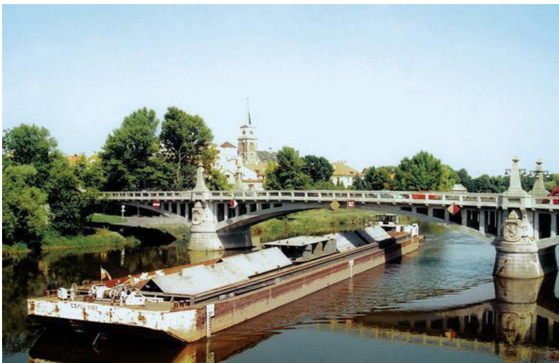
Obr. č. 11.: Návrhová tlačná sestava typu Europa II, plavební třída Va.
