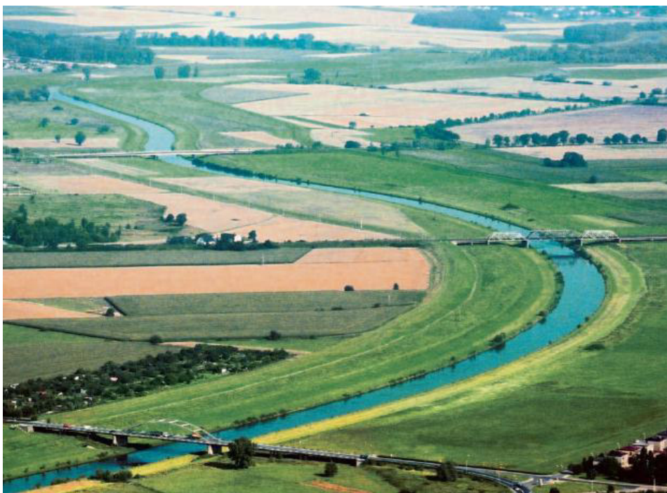
Obr. č. 24.: Odlehčovací rameno u polského Racibórz plně vyhovuje plavební třídě Vb.
