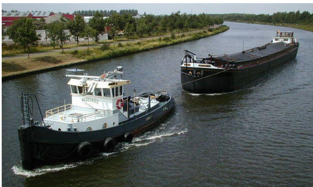
Obr. č. 7.: Návrhové plavidlo typu Kempenaar, plavební třída II.
