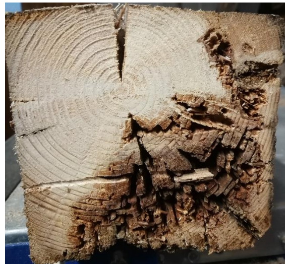
Obrázek 118: Ukázka hnědé hniloby v řezu
