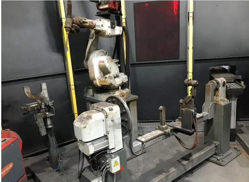
Obr. 8 Přípravek pro svařování stummelů.
