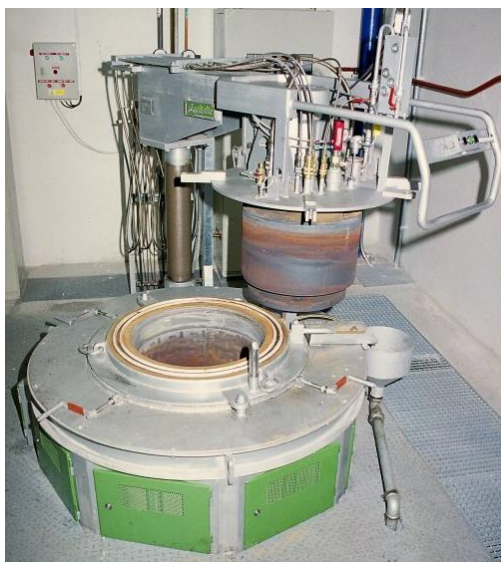
Obr. 21 Šachtová pec pro metodu MONOCARB [17].
