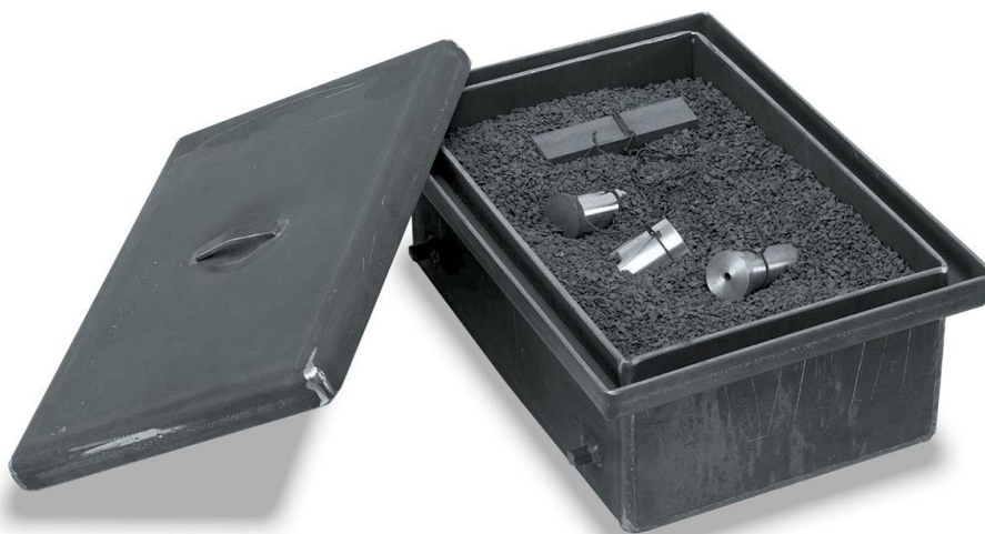
Obr. 18 Nádoba s cementační směsí a součástkami [14].
