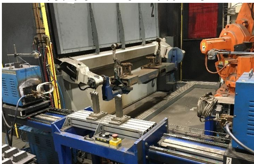
Obr. 9 Přípravek pro předehřev céček.
