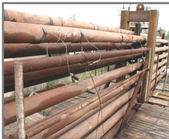
Obr. 2.2 Aplikace akustické emise na transportním potrubí [4]
