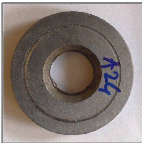
Obr. 4.1 Ukázka vzorku diskového tvaru s únavovým poškozením v kontaktní stopě viditelným pouhým okem
