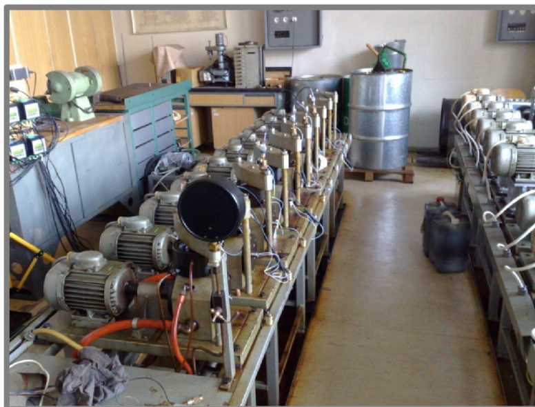
Obr. 2.3 Zkušebna ložisek v dílnách Ústavu konstruování
