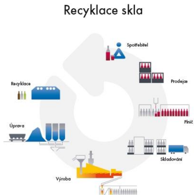
Obrázek 5: Fáze recyklace skla
