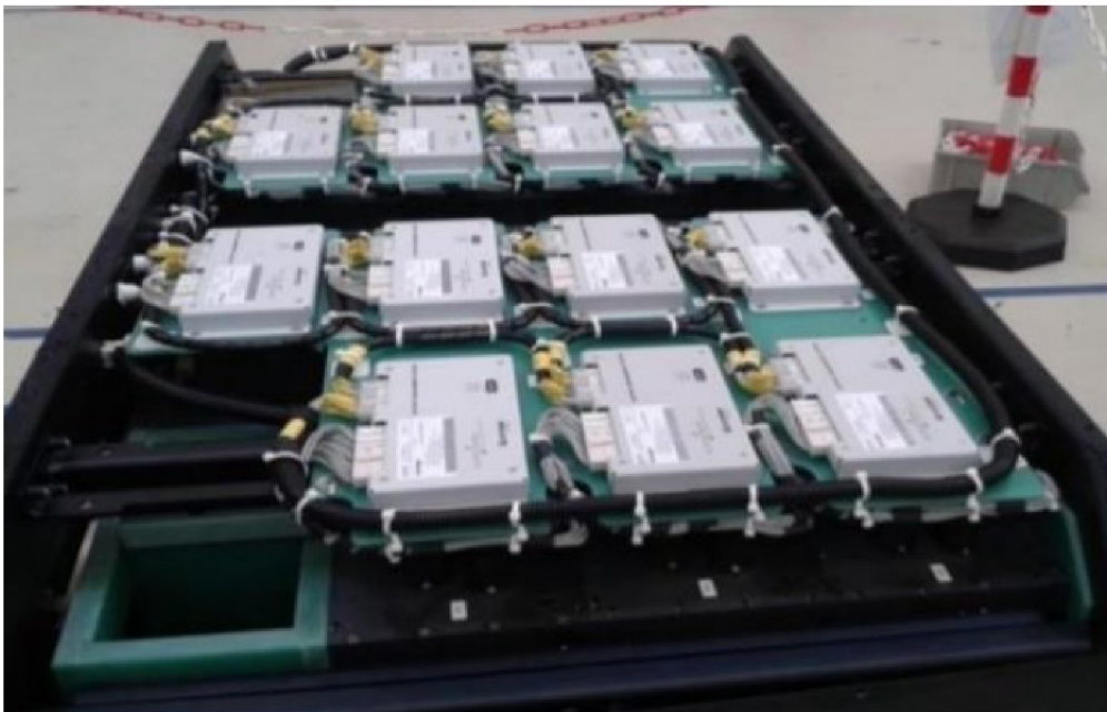
Obr. 3.4 Kontejner trakční baterie
