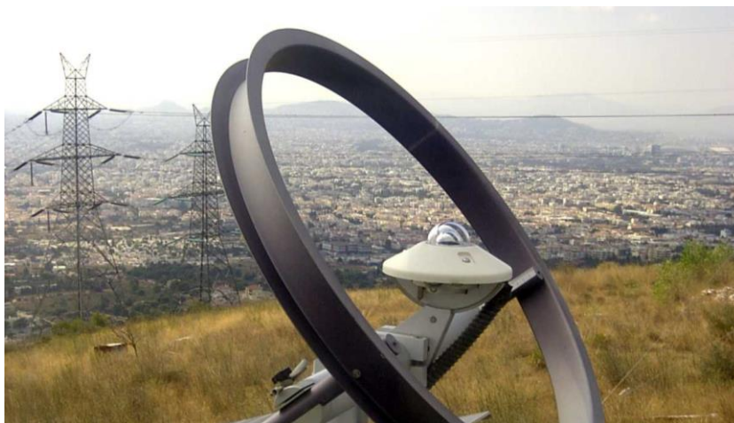
Obr. 4-6 - Pyranometr se stínícím prstencem [11]
