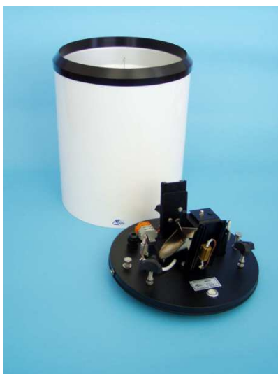
Obr. 1 člunkový srážkoměr MR3H (zdroj: meteoservis)
