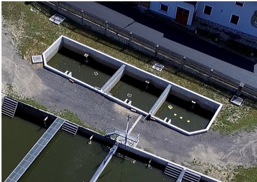
Obr. č. 16: Pokusné nádrže na sádkách Litschau s instalovanými světly, žlutými deskami a vzorkovacími boxy na náletový hmyz
