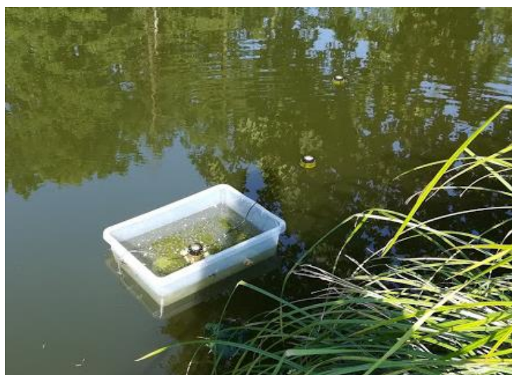
Obr. č. 3: Umístění světél (1 – 1,5 m od sebe) s odběrovým boxem na zemních rybníčích ve Vodňanech.
