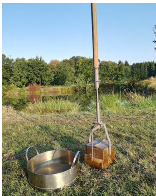
Obr. č. 9: Ekman-Birge odběrák a měděné síto určené pro odběr vzorků fauny dna.
