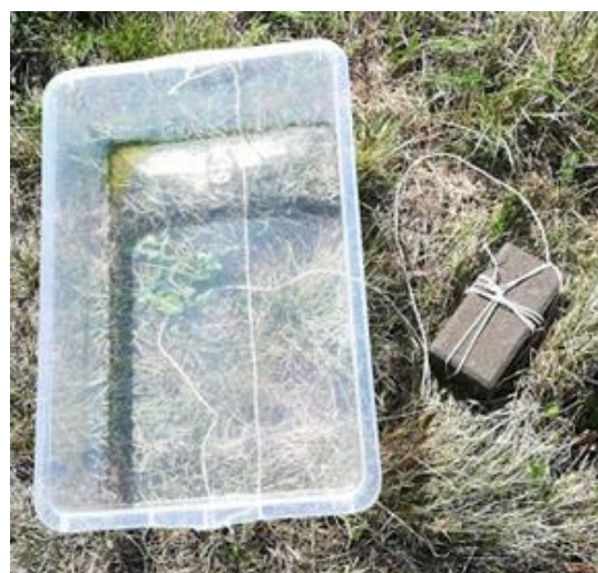
Obr. č. 12: Odběrový box instalovaný na kontrolní rybník se závažím.
