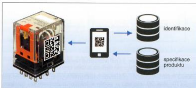
Obrázek 2: Údaje o relé zakódované do QR kódu [14]
