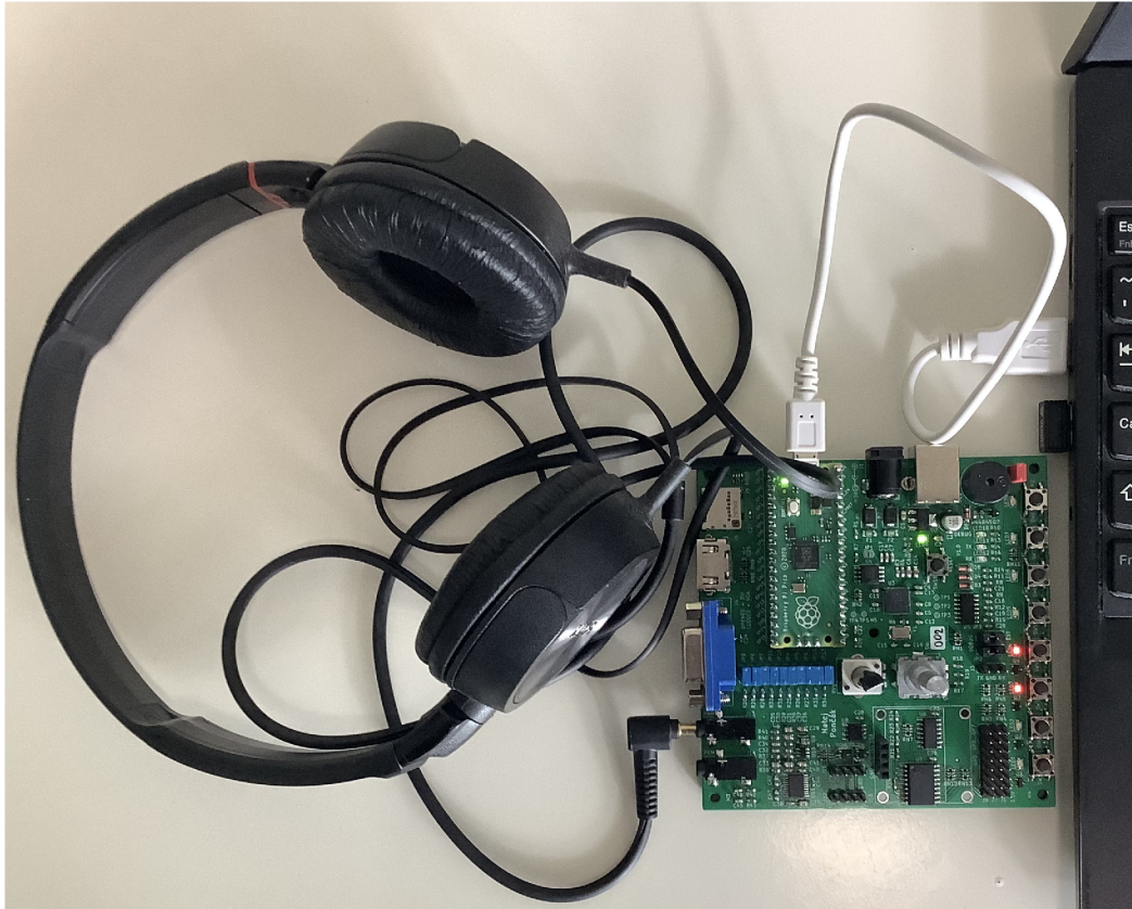
Obr. 6.2: Fotografie zapojení vývojového kitu RPi Pico Kit s Raspberry Pi Pico pro komunikaci s PC
