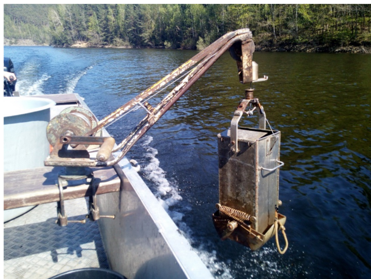
Obr. 10: Speciální zařízení určené k odběru vzorků sedimentu (foto: Petr Blabolil).
