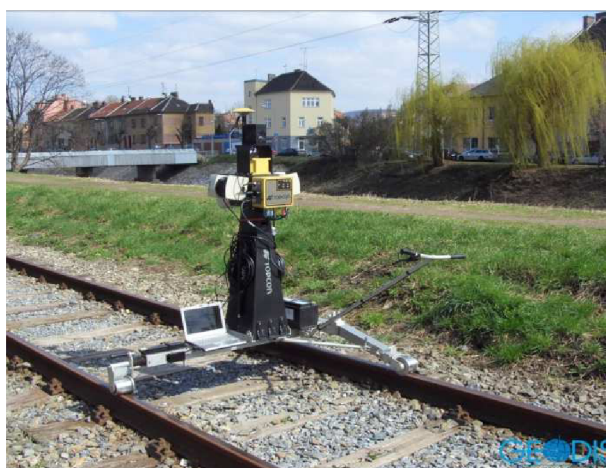
Obr. 2.1.3 Mobilní mapovací systém pro železniční aplikace [1]
