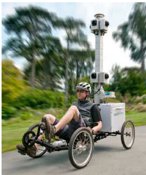
Obr. 2.1.4 Mobilní mapovací systém pro mapování pěších zón [5]
