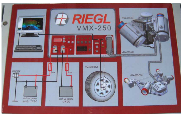
Obr. 3.1.3 Schéma propojení všech zařízení s řídicí jednotkou [9]
