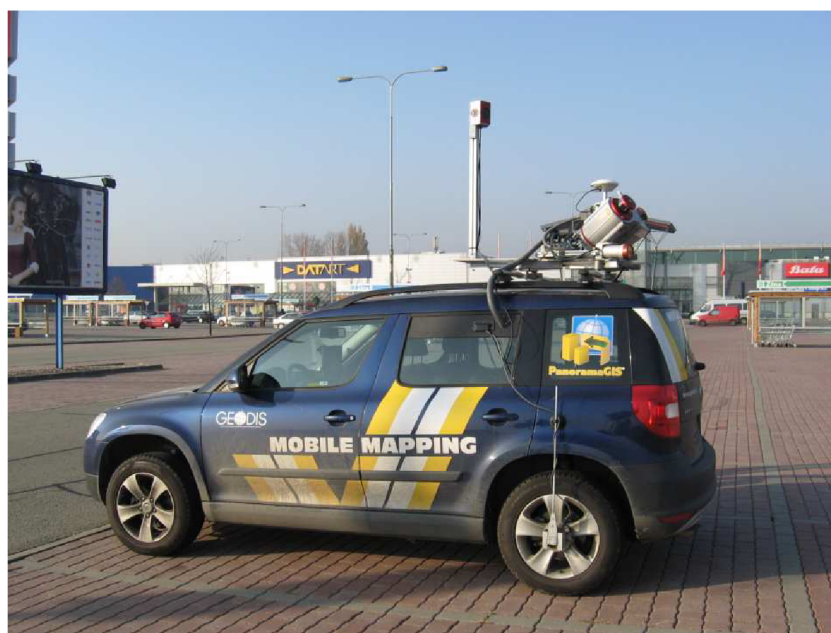
Obr. 3.1.1 Mobilní mapovací systém MOMAS [14]
