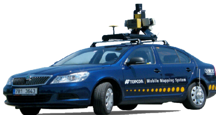
Obr. 2.1.1 Mobilní mapovací systém umístěný na autě [1]
