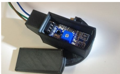
Obr. 2.11: Nástavce pro upevnění modulu optickým senzorem k vodoměru Sensus [13].
