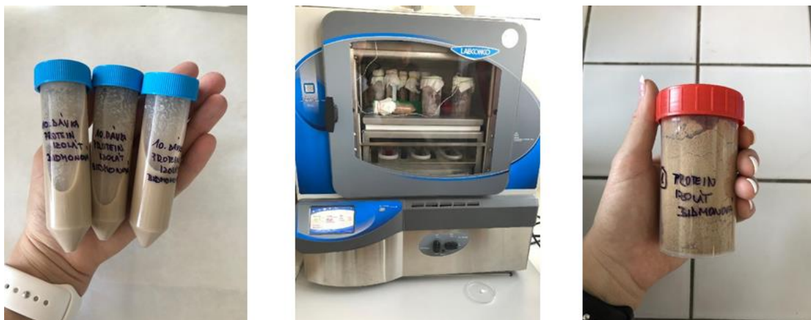
Obrázek 14: Vzorok před lyofilizací (A), lyofilizace (B), výsledný proteinový izolát (C)
