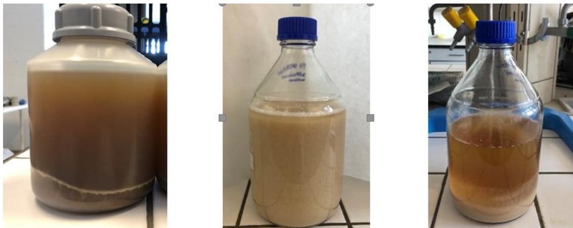
Obrázek 13: Vzorek před centrifugací (A), vzorek po vysrážení (B), vzorek po vysrážení a sedimentaci (C)
