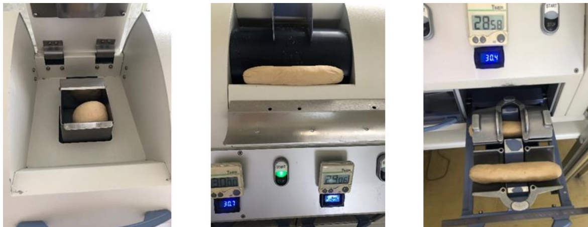
Obrázek 16: Klonek vytvořený ve skulovači (A), váleček vytvarovaný ve vyvalovači (B), temperovaná komora k odležení vzorku (C)
