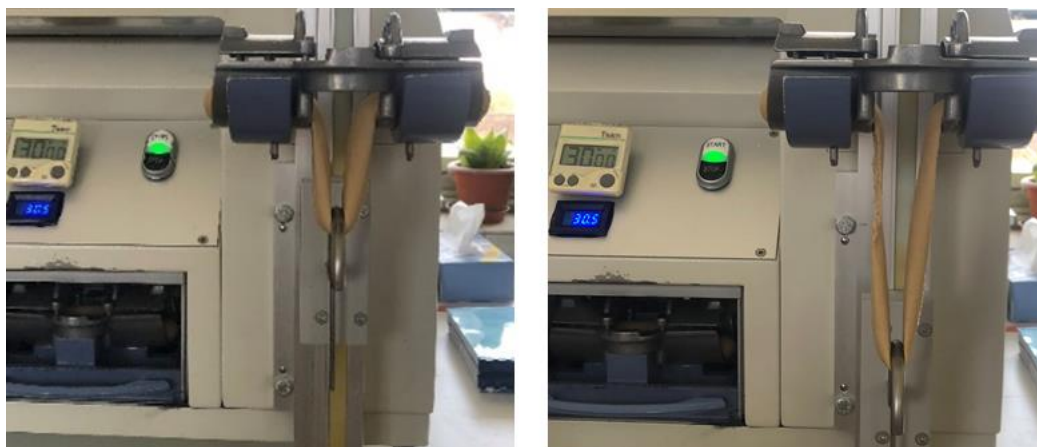
Obrázek 17: Natahování těsta hákem (A), moment přetržení těsta hákem (B)
