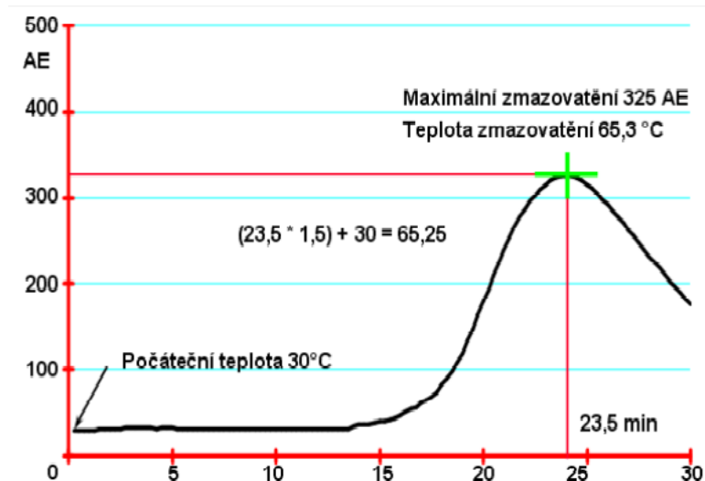
Obrázek 9: Ukázkové znázornění amylografické křivky [47]
