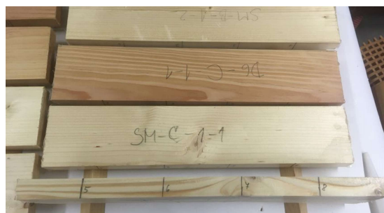
Obrázek 13: Zkušební těleso s kódovým označením, na boční straně tělesa viditelné značky pro pozdější měření
