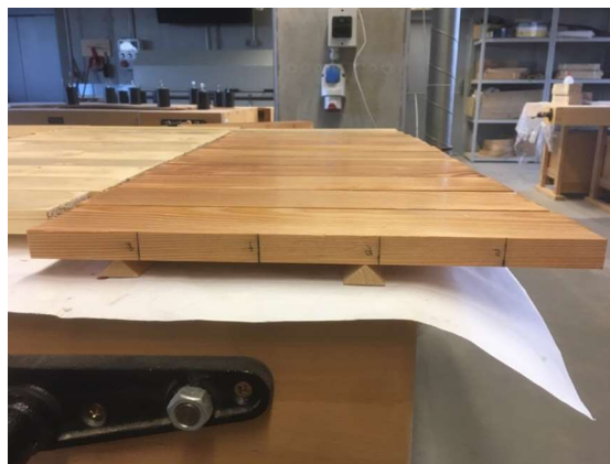
Obrázek 15: Zkušební tělesa po natření s viditelným značením na boční ploše
