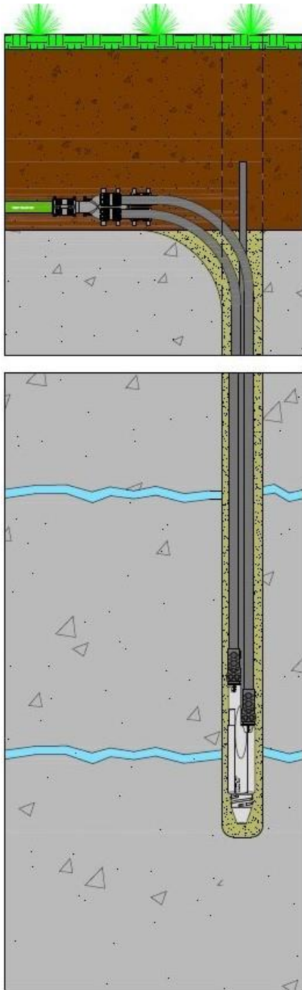
Obr. 3.6: Prierez vrtom pre TČ zem - voda [10]
