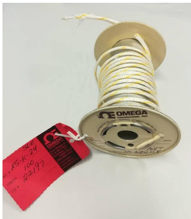
Obr. 5.4: Termočlánkový drôt na výrobu termočlánkov.
