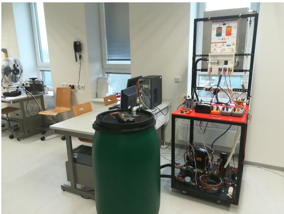
Obr. 4.1: Tepelné čerpadlo vzduch - voda v laboratóriu VUT.
