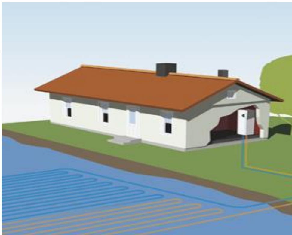
Obr. 3.9: TČ voda - voda využívajúce vodnú plochu [14].
