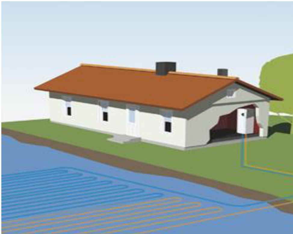
Obr. 3.9: TČ voda - voda využívajúce vodnú plochu [14].
