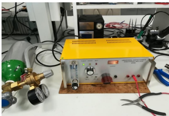
Obr. 5.5: Pracovisko pre zváranie termočlánkov.
