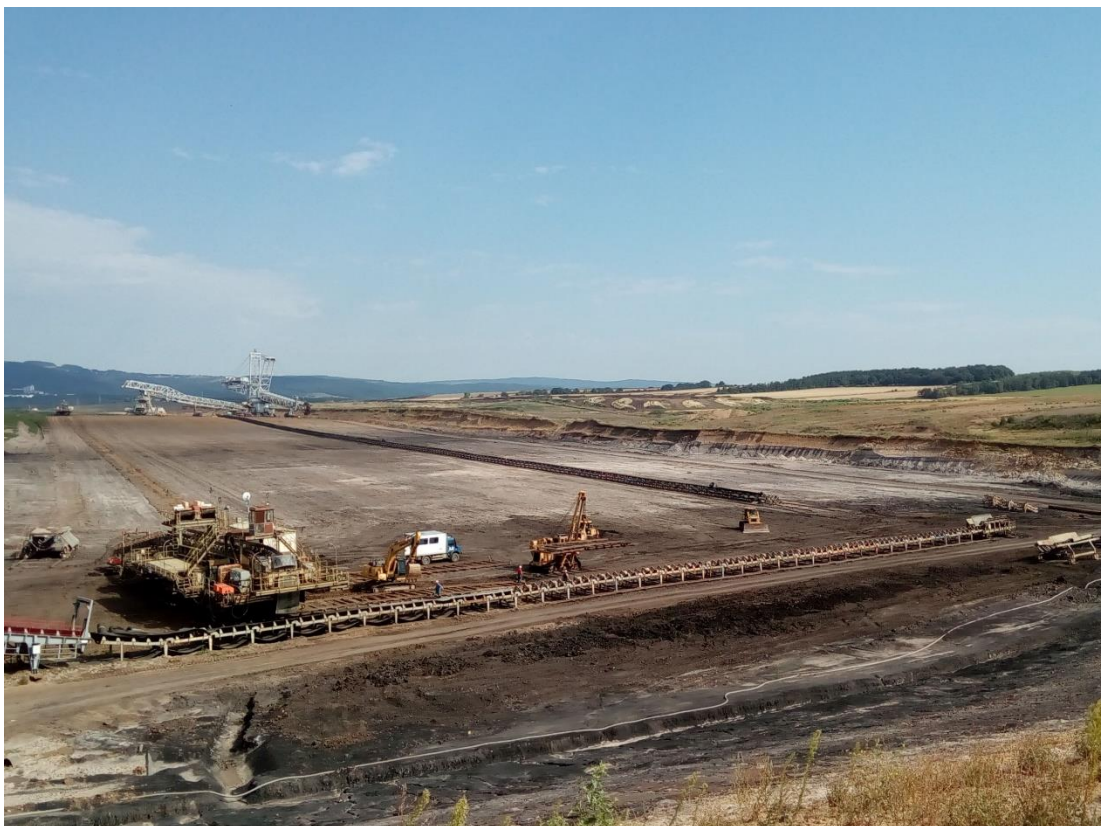
Obrázek 11: Skrývka nadložních zemin na DNT, lokalita Libouš.
