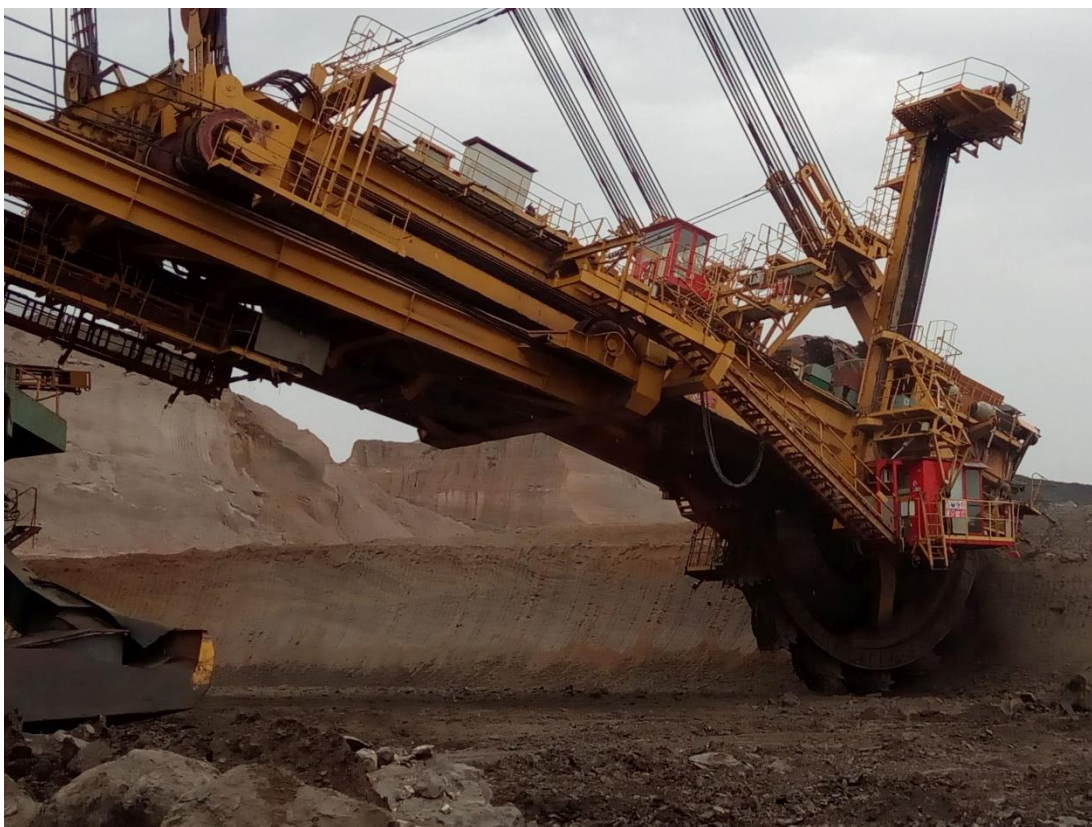
Obrázek 12: Těžba nadložních zemín – kolesové rýpadlo KU 800.
