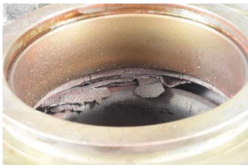
Obr. 12) Cizí materiál nalezený v testu na motoru u zákazníka [foto autor]
