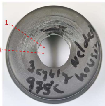
Obr. 58) Naznačení řezů pro vytvoření metalografických vzorků [foto autor]
