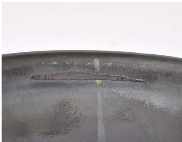
Obr. 69) Kus cizího materiálu na vnitřní straně štítu [foto autor]
