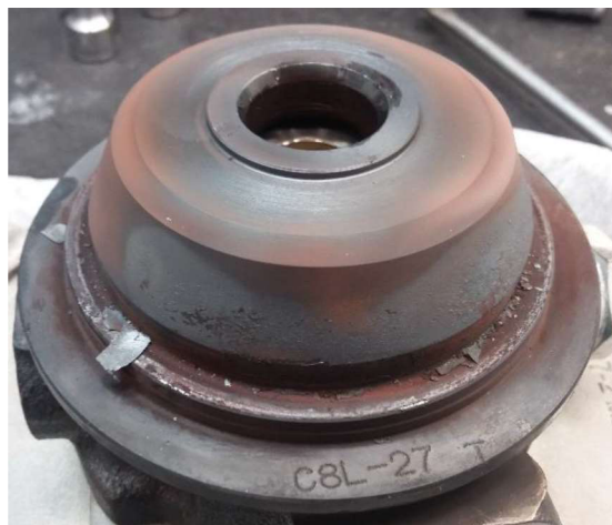
Obr. 70) Ložisková skříň po testu s odloupanou povrchovou oxidací [foto autor]
