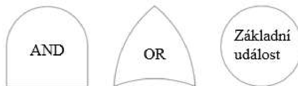
Obr. 9) Často používané značky pro diagram FTA
