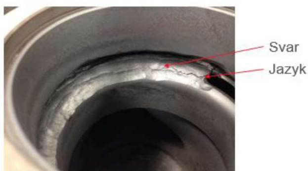
Obr. 14) Turbínová skříň po zavaření jedné z volut [foto autor]
