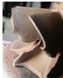
Obr. 13) Detail lopatek turbínového kola poškozeného cizím materiálem ve volutě [foto autor]
