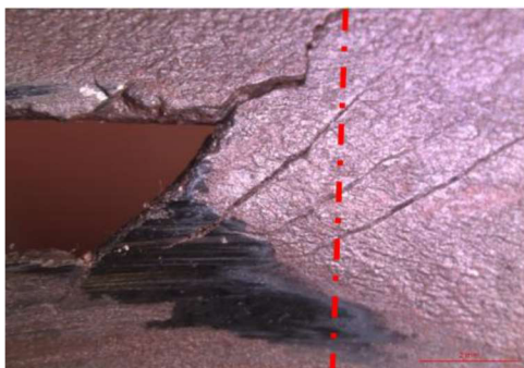
Obr. 44) Naznačení řezu pro vytvoření metalografického vzorku [foto autor]
