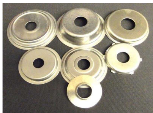
Obr. 7) Příklad tepelných štítů, používaných u LDV [23]
