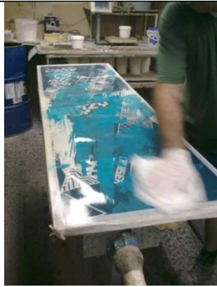
Obrázok 17: Čistenie fólie. Zdroj: vlastný, s dovolením Crazy Fly s.r.o.
