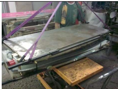
Obrázok 15: Doska odvázaná na šušenie v ohrievači. Zdroj: vlastný, s dovolením Crazy Fly s.r.o.
