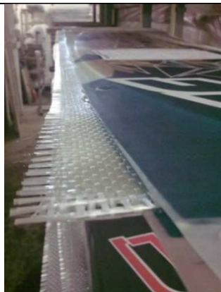
Obrázok 18: Detail na zalepený sklolaminát. Zdroj: vlastný, s dovolením Crazy Fly s.r.o.
