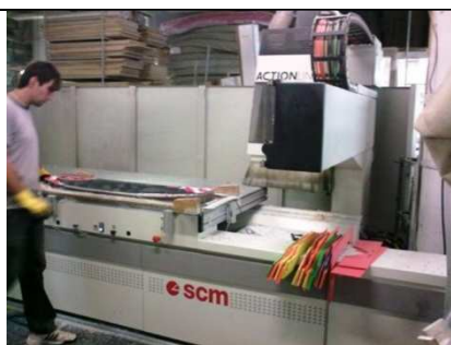
Obrázok 19: Orezávanie laminátu na CNC stroji. Zdroj: vlastný, s dovolením Crazy Fly s.r.o.
