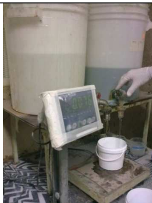
Obrázok 9: Miešanie lepiacej zmesi. Zdroj: vlastný, s dovolením Crazy Fly s.r.o.
