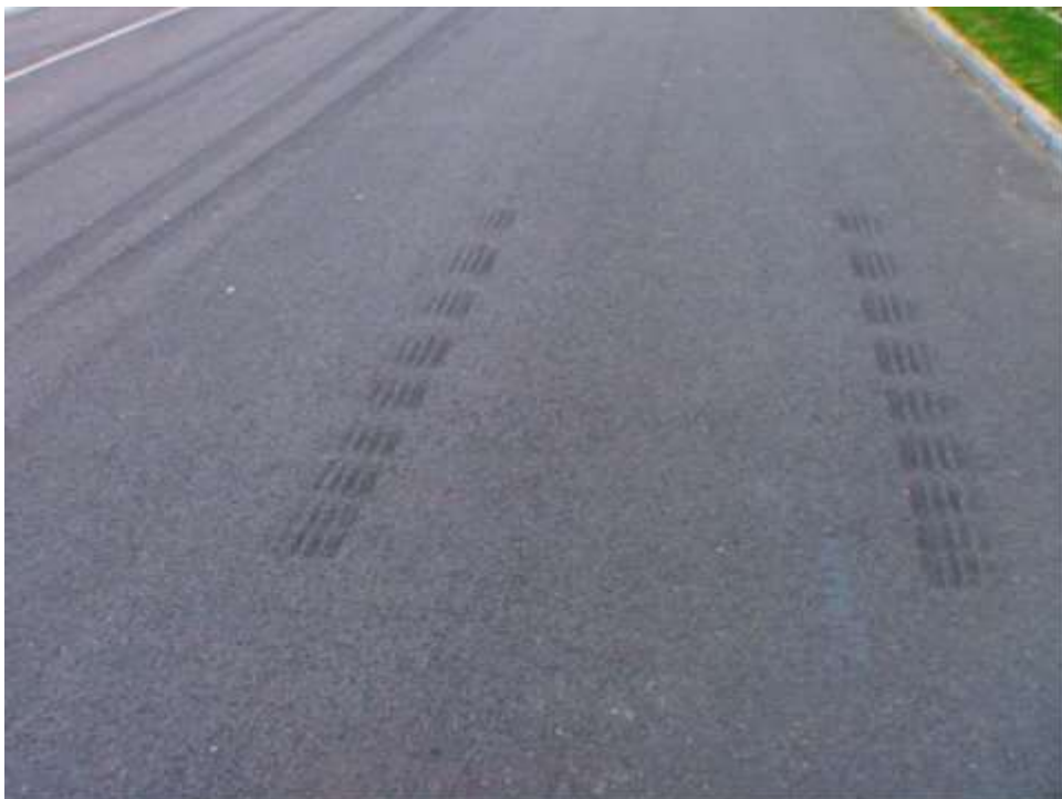
Obr. 16 - Charakteristická brzděná stopa s ABS [25]
