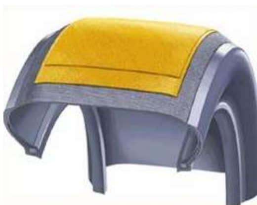
Obr. 7 - Korunní kordová vrstva, nárazník [19]
