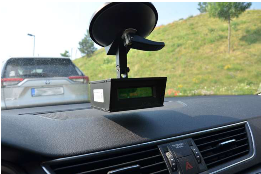
Obr. 20 XL Meter s umístěním na čelním skle
