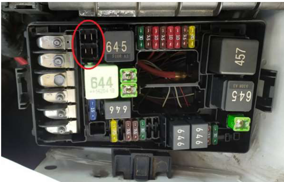
Obr. 23 : Pojistková skříň Škoda Superb, deaktivované ABS
