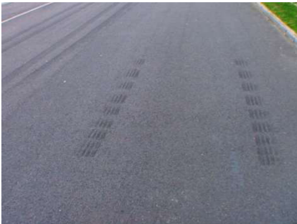
Obr. 16 - Charakteristická brzdná stopa s ABS [25]
