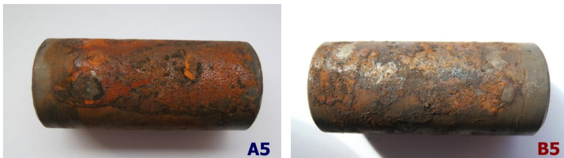
Obr. 61 Vzorky nitridované v plynu do hloubky 0,3 mm po zkoušce solnou mlhou
