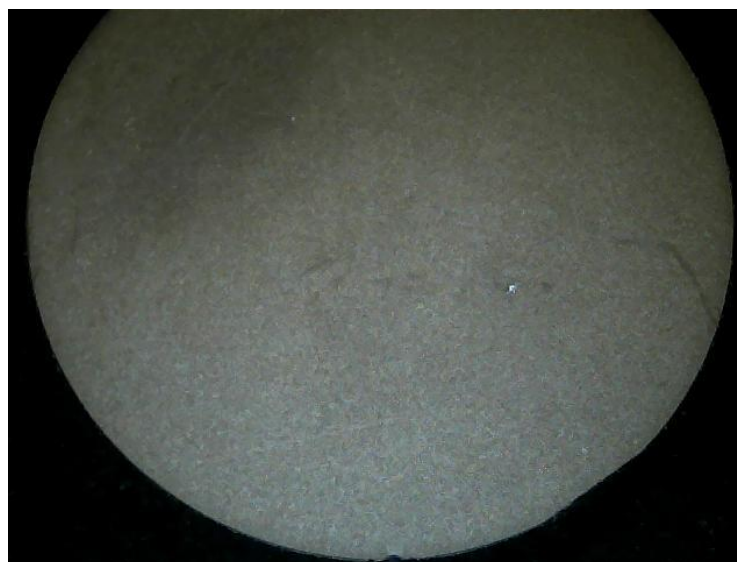
Obr. 16 Příčný řez zušlechtěným vzorkem oceli ČSN 14 220
