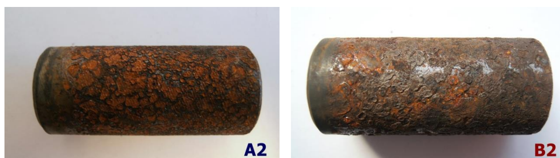
Obr. 58 Cementované vzorky po zkoušce v solné mlze
