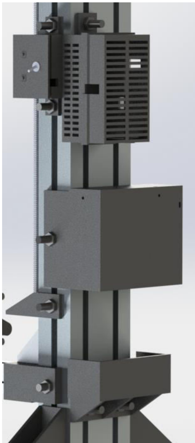
Obrázek 5.7 Uchycení zdroje, desky Arduino s Shield Ramps, AD převodníku a uživatelské rozhraní
