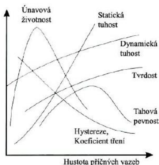
Obrázek 2: Vliv vulkanizace na vlastnosti materiálu [2]
