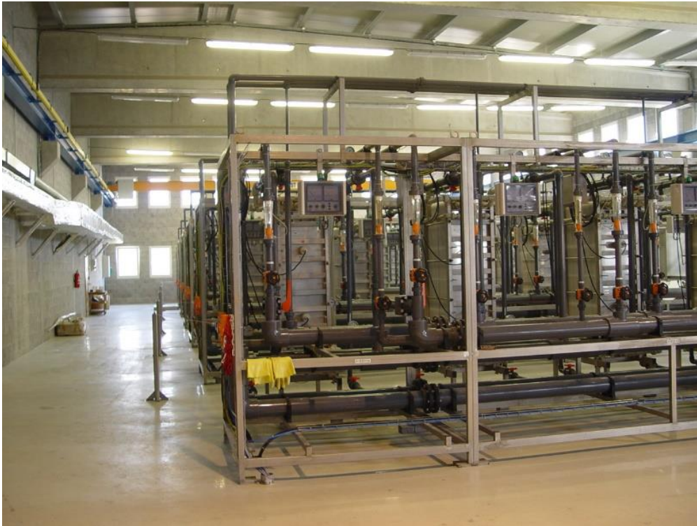
Příloha 9 Technologie čištění vod pomocí membránových procesů – elektrodialýza
