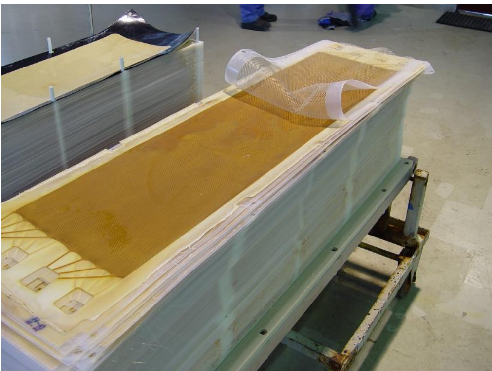
Příloha 10 Nečistoty na lamelách dialyzační jednotky
