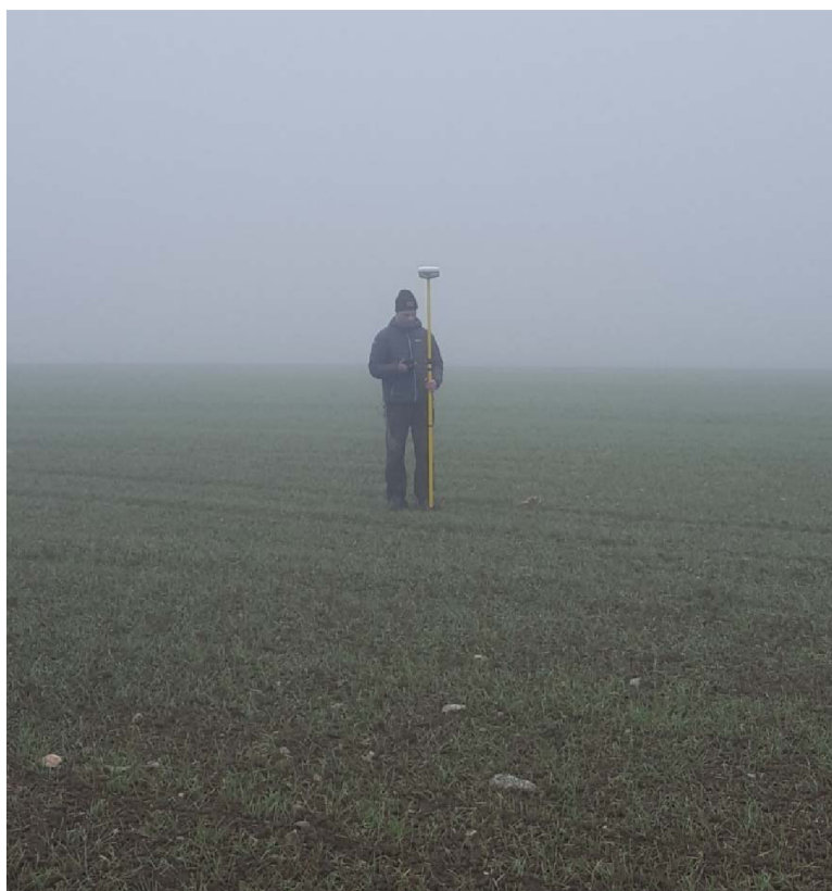
Obrázek 6 Ukázka měření GNSS aparaturou Trimble R4 na lokalitě
