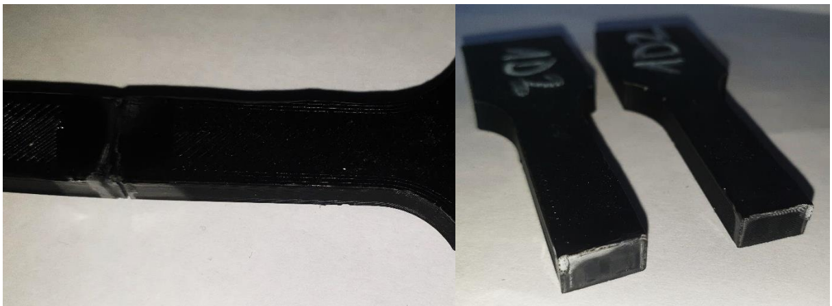
Obr. 37 Ukázka poškození vzorků 1D1 a 1D2.
