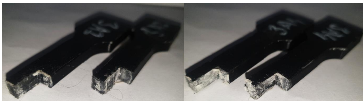
Obr. 44 Ukázka poškození vzorků 3A2 a 3A4.
