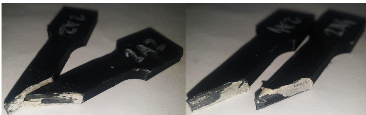
Obr. 39 Ukázka poškození vzorků 2A2 a 2A4.
