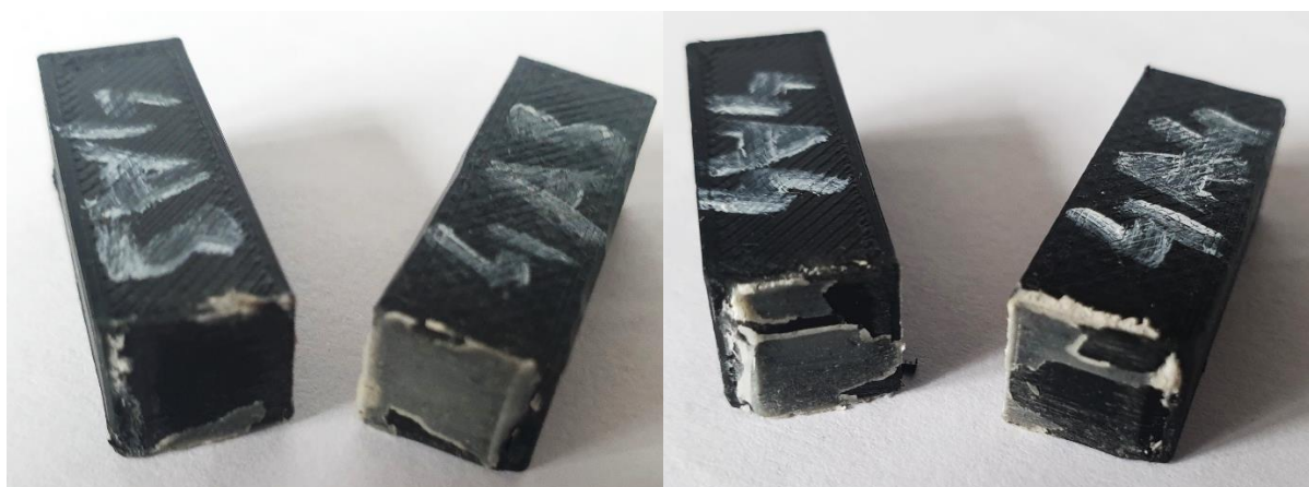
Obr. 53 Ukázka poškození vzorků 4A3 a 4A4.
