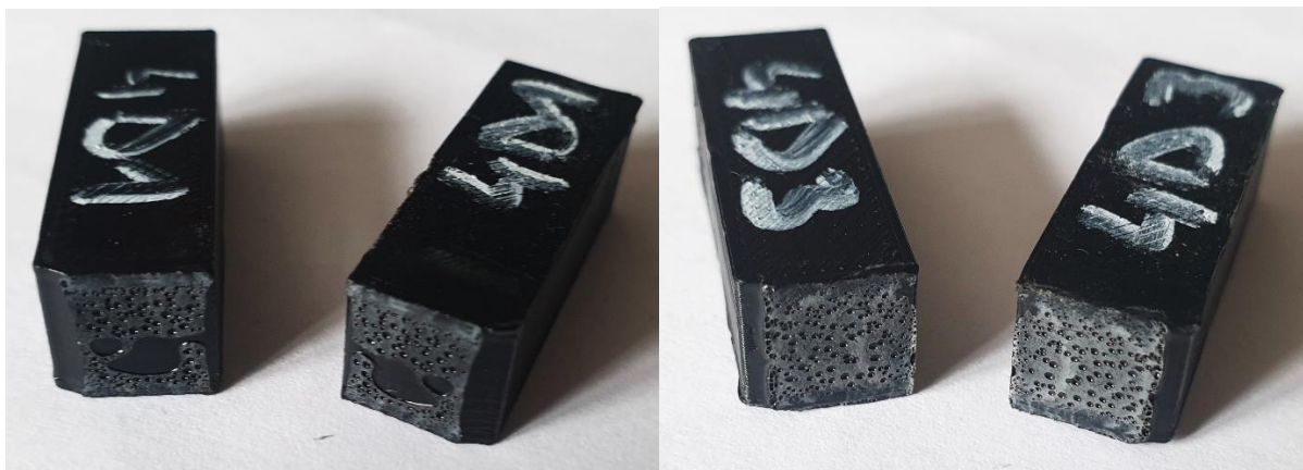
Obr. 56 Ukázka poškození vzorků 4D1 a 4D3.
