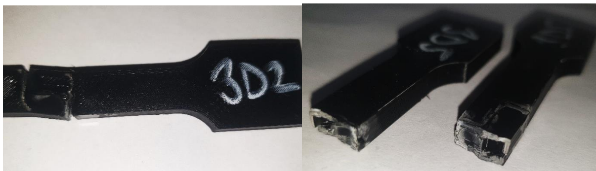
Obr. 47 Ukázka poškození vzorků 3D2 a 3D5.
