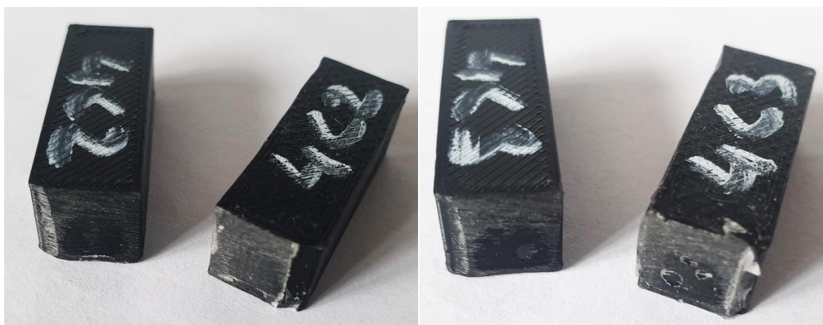
Obr. 55 Ukázka poškození vzorků 4C2 a 4C3.
