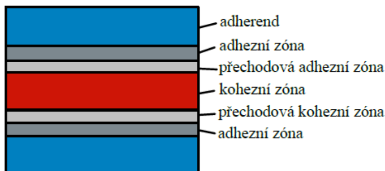
Obr. 4 Popis jednotlivých oblastí v lepeném spoji [15].
