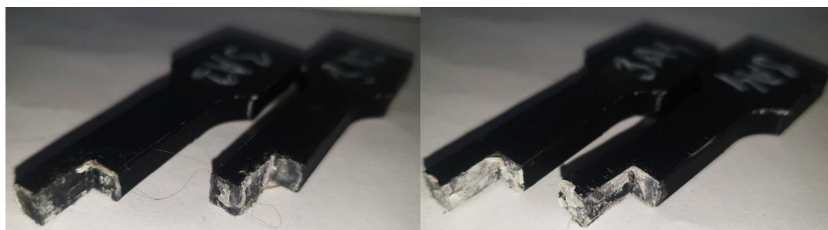
Obr. 44 Ukázka poškození vzorků 3A2 a 3A4.
