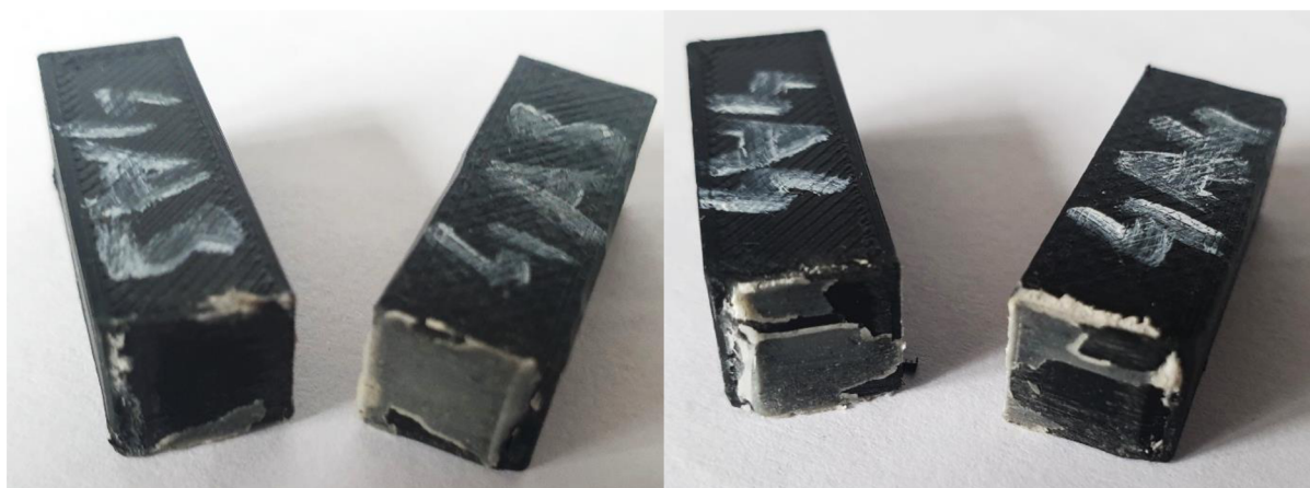
Obr. 53 Ukázka poškození vzorků 4A3 a 4A4.
