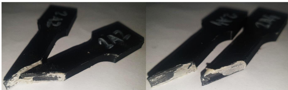
Obr. 39 Ukázka poškození vzorků 2A2 a 2A4.
