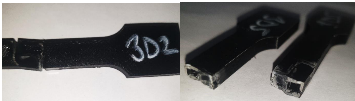
Obr. 47 Ukázka poškození vzorků 3D2 a 3D5.
