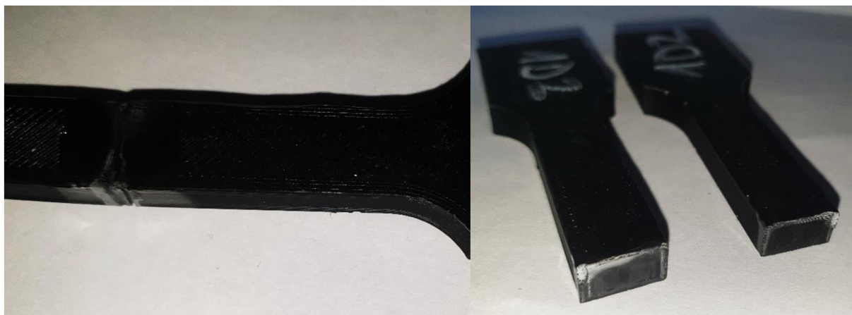
Obr. 37 Ukázka poškození vzorků 1D1 a 1D2.
