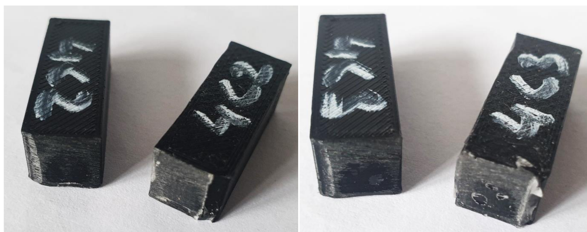
Obr. 55 Ukázka poškození vzorků 4C2 a 4C3.
