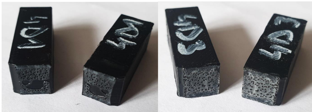
Obr. 56 Ukázka poškození vzorků 4D1 a 4D3.
