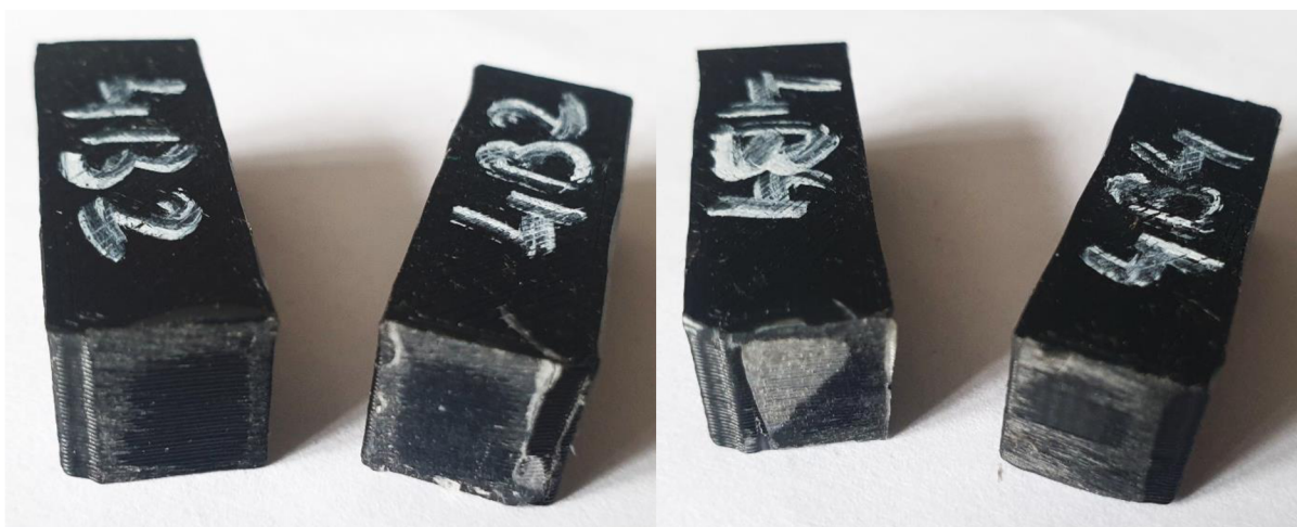
Obr. 54 Ukázka poškození vzorků 4B2 a 4B4.
