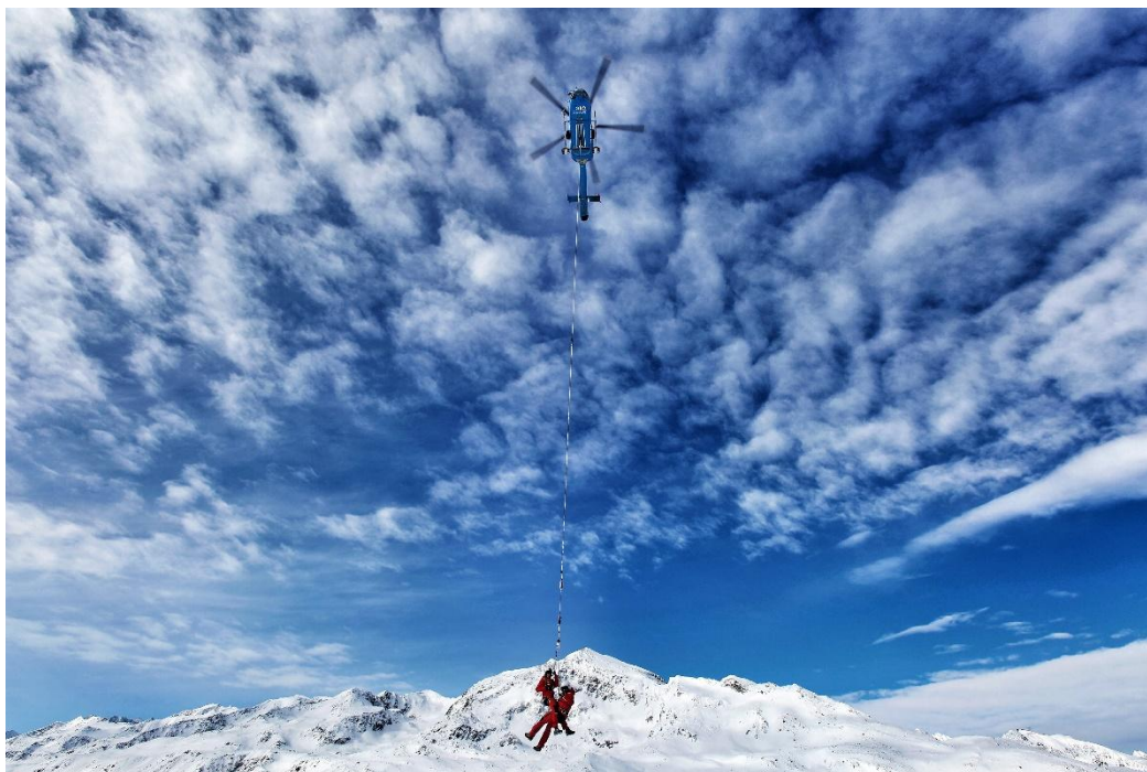
Obrázek 16 Transport leteckých záchranářů s využitím podvěsu (HEC)
