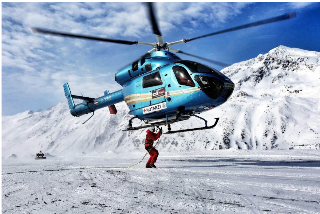
Obrázek 14 Upevnění podvěsu do kotvícího systému (HEC)
